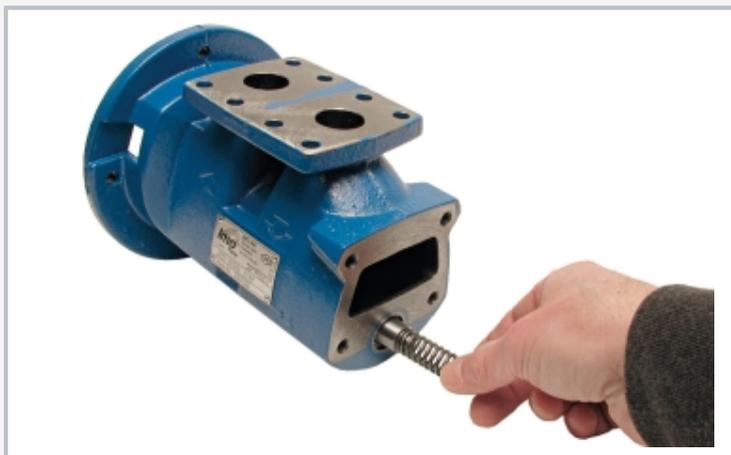
Montaje de la bomba de tornillo: montar el émbolo de válvula con resorte de válvula
