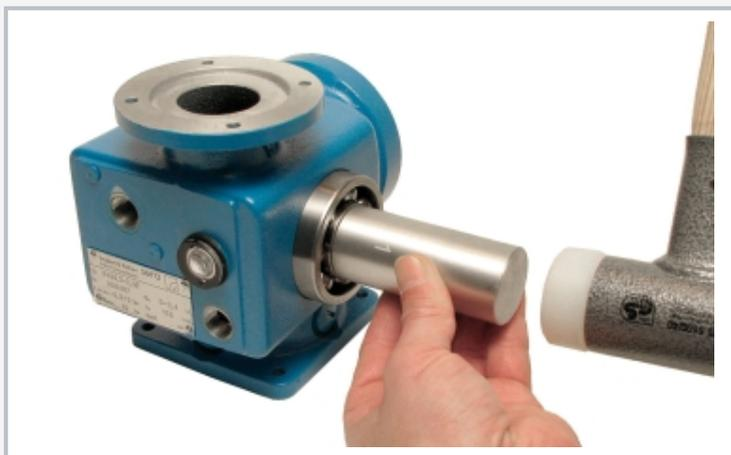
Montaje de la bomba de diafragma: hincar la excéntrica en la caja (por medio de un dispositivo)
