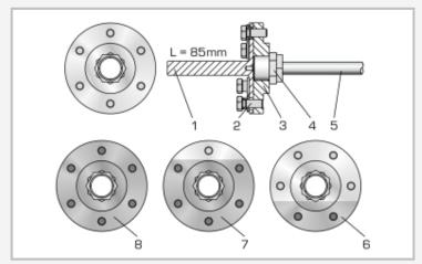
1 brida con árbol corto (carga con transmisión por correa), 2 tornillo, 3 plato tomador, 4 juego de sujeción, 5 árbol impulsor, 6 árbol con fisura máxima (unión de brida con 2 tornillos portantes), 7 árbol con fisura pequeña (unión de brida con 5 tornillos portantes), 8 árbol sin fisura (unión de brida con 6 tornillos portantes)
