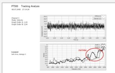
Seguimiento ("tracking") de un rotor con fisura: claro aumento de la amplitud en el segundo orden (marcado en rojo)
