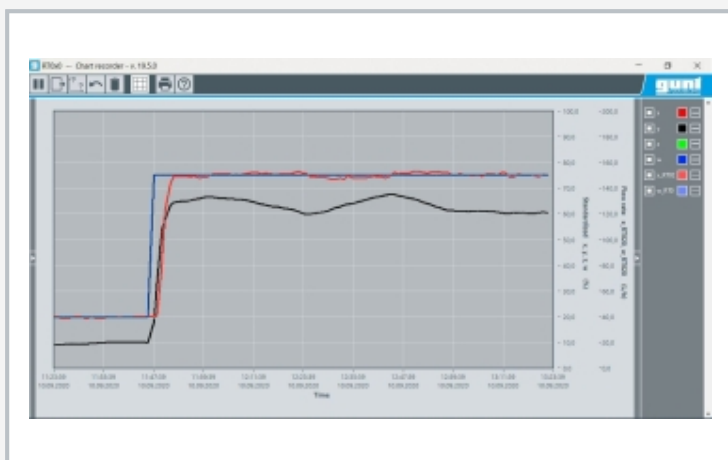
Captura de pantalla del software: regulación de caudal con regulador PI, escalón de variable de referencia
