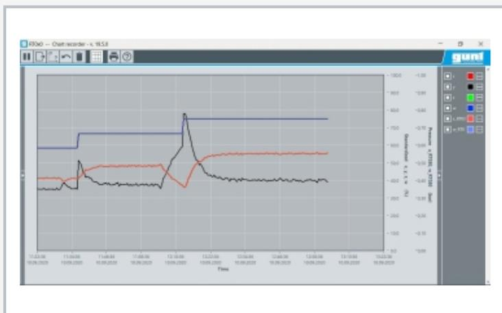
Captura de pantalla del software: regulación de presión con regulador P continuo, escalones en la variable de referencia y desviación de la regulación permanente en la variable controlada
