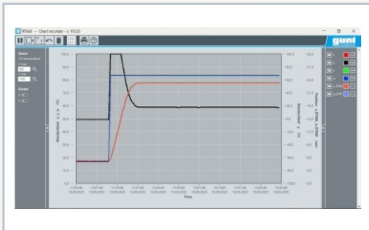
Captura de pantalla del software: regulación de la posición con regulador P, escalón de la variable de referencia con desviación de la regulación permanente de la variable controlada
