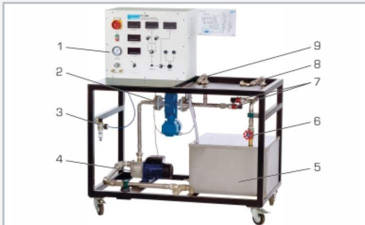
1 armario de distribución con elementos de mando, 2 sensor de caudal, 3 válvula de desahogo de presión de entrada, 4 bomba, 5 depósito, 6 ajuste del caudal, 7 sensor de presión, 8 salida de agua válvula de control, 9 entrada de agua válvula de control
