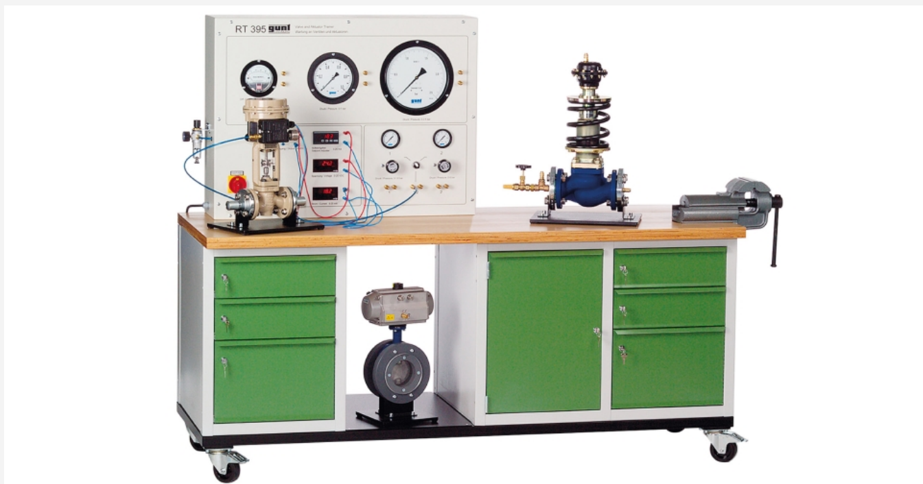
La ilustración muestra el equipo RT 395 con 3 de 4 válvulas (la válvula de sector de bola no está representada).
