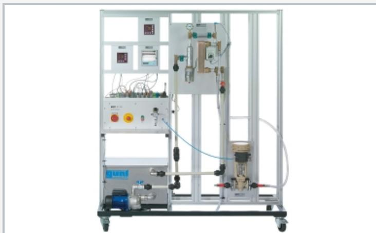
La ilustración muestra la estructura de una regulación de temperatura. Además del módulo básico RT 450 están incluidos los siguientes componentes: RT 450.04 (módulo del sistema controlado: temperatura), RT 450.11 (regulador), RT 450.12 (registrador), RT 450.21 (válvula de control) y RT 450.36 (sensor de temperatura).
