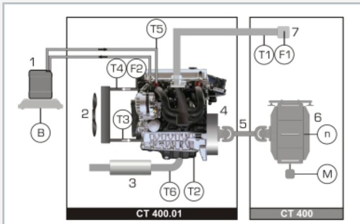
1 depósito de combustible, 2 radiador, 3 escape, 4 motor, 5 árbol de transmisión, 6 freno de corrientes parásitas, 7 entrada de aire; n número de revoluciones, M par, B consumidor de combustible, caudal volumétrico: F1 aire, F2 agua de refrigeración, temperaturas: T1 aire de aspiración, T2 aceite, T3 entrada de agua de refrigeración, T4 salida de agua de refrigeración, T5 combustible, T6 gases de escape
