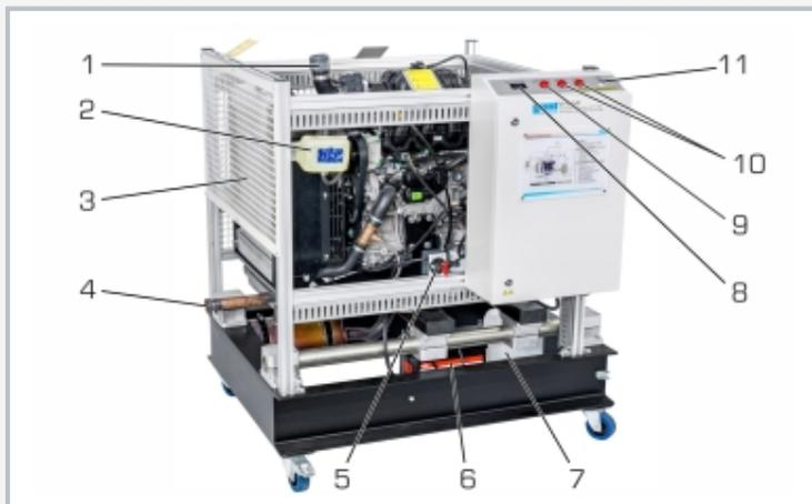
1 conexión para aire entrante del motor, 2 depósito de agua de refrigeración, 3 radiador con rejilla protectora, 4 conexión de gas de escape, 5 interruptor principal de batería, 6 batería, 7 depósito de combustible, 8 contador de horas de servicio, 9 lámpara de control del motor, 10 testigos, 11 interruptor de llave para encendido
