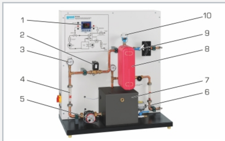
1 regulador, 2 válvula de control, 3 termómetro, 4 rotámetro, 5 bomba, 6 calefactor con termostato, 7 depósito, 8 cambiador de calor de placas, 9 válvula de bola con escala, 10 sensor de temperatura en la salida de agua fría
