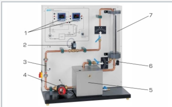
1 regulador, 2 válvula de control, 3 rotámetro con salida eléctrica, 4 bomba, 5 depósito de reserva, 6 sensor de presión para medir el nivel, 7 depósito de nivel con rebosadero
