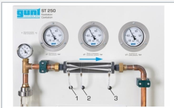
Medición de la presión en el tubo Venturi con 3 puntos de medición y manómetros:  $p_1$  presión en la entrada,  $p_2$  presión en la sección transversal más estrecha,  $p_3$  presión en la salida; flecha azul: dirección del flujo
