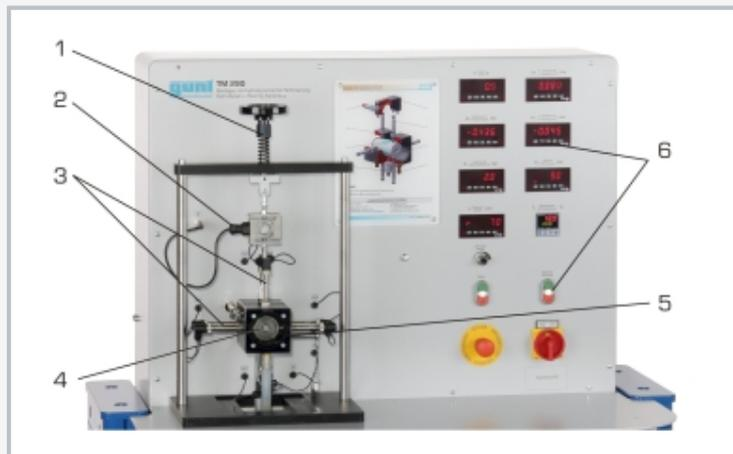
1 volante manual para carga, 2 sensor de fuerza para par de rozamiento, 3 sensor de desplazamiento inductivo, 4 árbol, 5 caja de cojinete, 6 elementos de indicación y mando
