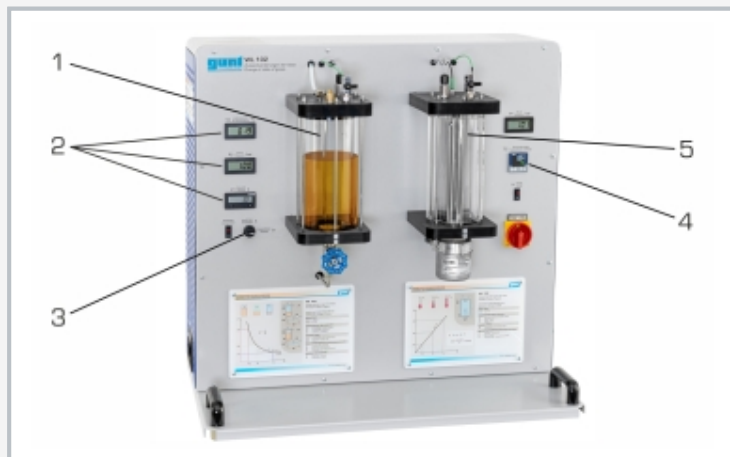
1 depósito 1 para cambio de estado isotérmico, 2 indicadores digitales, 3 cambiar entre compresión/expansión a válvula de 5/2 vías, 4 regulador de calefacción, 5 depósito 2 para cambio de estado isocórico
