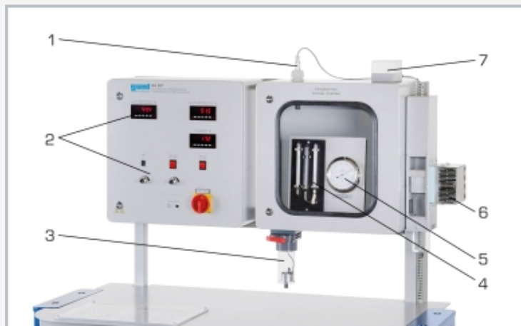
1 sensor de humedad capacitivo, 2 elementos de indicación y mando, 3 humectador, 4 psicrómetro, 5 higrómetro de cabello, 6 deshumectador, 7 higrómetro con fibras sintéticas y sensor de temperatura combinado
