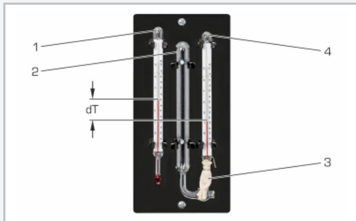
Psicrómetro: 1 termómetro de bulbo seco, 2 depósito de agua, 3 paño de algodón húmedo de envasado el termómetro de bulbo húmedo, 4 termómetro de bulbo húmedo; dT diferencia de temperatura
