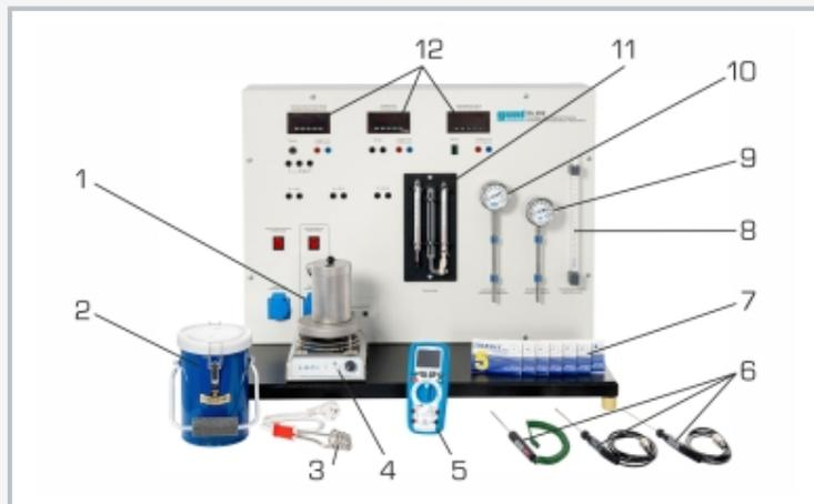
1 caja de enchufe regulada por potencia, 2 termo, 3 calentador de inmersión, 4 calentador de laboratorio para agua y arena, 5 multímetro, 6 sensores de temperatura, 7 cintas de medición de temperatura, 8 termómetro de mercurio, 9 termómetro bimetálico, 10 termómetro de gas presurizado, 11 psicrómetro para determinar la humedad del aire, 12 indicador digital para sensores de temperatura
