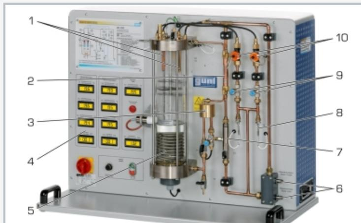
1 condensadores, 2 cambiador de calor, 3 purgador del agua de vapor, 4 indicaciones para temperatura, caudal y presión, 5 dispositivo de calefacción, 6 conexiones para agua de refrigeración, 7 trompa de agua, 8 sensor de temperatura, 9 válvula para ajustar el agua de refrigeración, 10 sensor de caudal para agua de refrigeración
