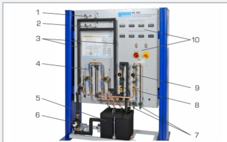
1 válvula de purga, 2 sensor de temperatura, 3 cambiador de calor, 4 grifo de bola para el ajuste del modo de funcionamiento, 5 depósito con dispositivo de calefacción, 6 bomba, 7 conexiones de agua, 8 caudalímetro, 9 válvula para el ajuste del caudal, 10 elementos de indicación y mando
