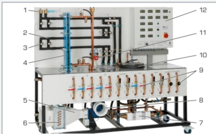
1 válvula de purga, 2 cambiador de calor de tubos concéntricos, 3 sensor de temperatura, 4 cambiador de calor de placas, 5 conducto de aire, 6 cambiador de calor de tubos de alas, 7 cambiador de calor de carcasa y tubos, 8 soplante, 9 válvulas de ajuste, 10 depósito de agitación con doble camisa y serpentín, 11 sensor de presión (agua), 12 armario de distribución
