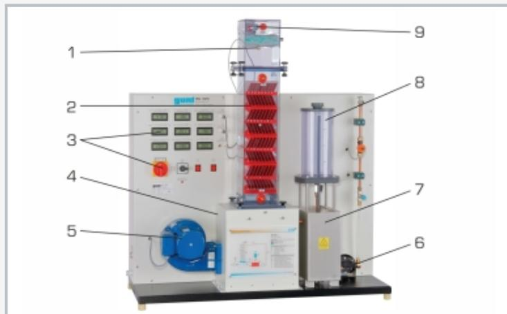
1 tobera como pulverizador, 2 instalaciones de rociado, 3 elementos de indicación y mando, 4 cámara de aire, 5 soplante con válvula de mariposa, 6 bomba, 7 depósito con calefacción, 8 depósito para agua adicional, 9 sensor combinado de temperatura/humedad
