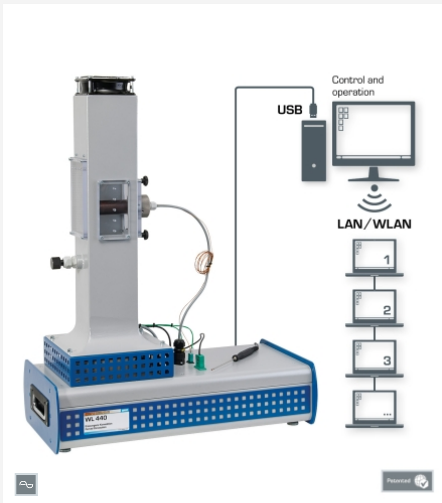
Montaje experimental completo con un PC para el control y la operación y cualquier número de estaciones de trabajo con el software GUNT para la observación y evaluación de los ensayos.
