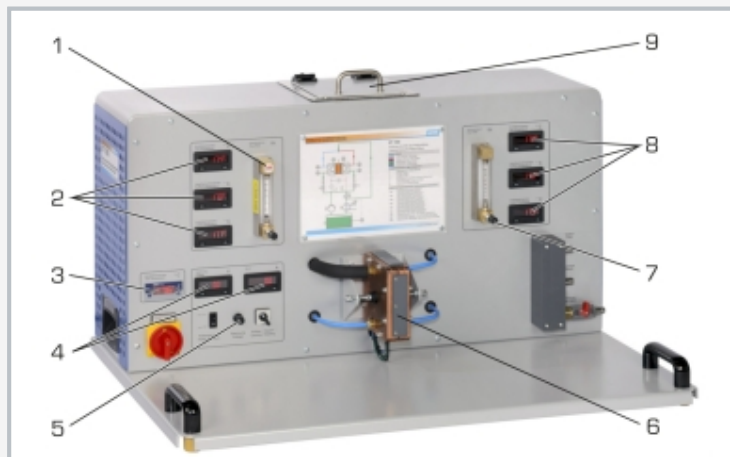
1 caudalímetro agua fría, 2 indicadores de temperatura lado frío, 3 regulador de temperatura depósito de agua, 4 indicadores de tensión y corriente, 5 ajuste de la potencia eléctrica, 6 elemento Peltier con cambiadores de calor, 7 caudalímetro agua caliente, 8 indicadores de temperatura lado caliente, 9 tapa de depósito de agua
