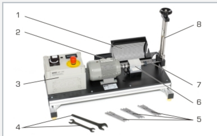
1 cubierta protectora, 2 motor eléctrico, 3 caja de distribución, 4 herramienta, 5 probetas, 6 apoyo, 7 probeta fijada, 8 dispositivo de carga con balanza de resorte y volante manual
