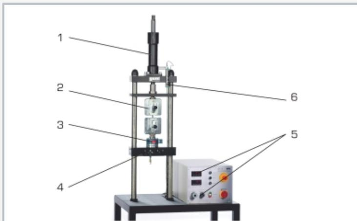
1 cilindro hidráulico para la generación de fuerzas de tracción y compresión, 2 área de trabajo con accesorio WP 310.05, 3 sensor de fuerza, 4 travesaño inferior ajustable en altura con bloqueo, 5 elementos de indicación y mando, 6 sensor de desplazamiento
