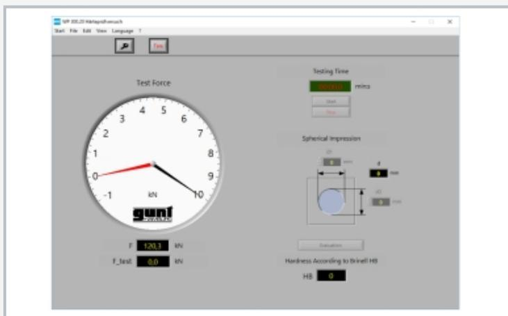
Captura de pantalla del software: ensayo de dureza según Brinell
