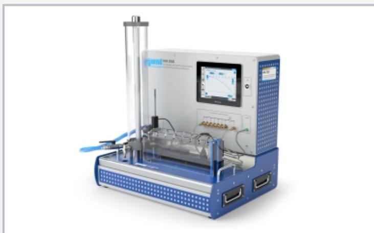
La ilustración muestra el accesorio HM 250.06 sobre la superficie de trabajo del módulo básico HM 250
