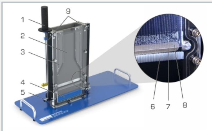
1 corredera para la limpieza de la superficie transparente, 2 canal de flujo, 3 modelos para modificaciones en la sección transversal, 4 inserto de espuma para estabilizar el agua, 5 alimentación de agua, 6 rectificador de nido de abeja, 7 alambre de platino como cátodo, 8 placa de acero inoxidable como ánodo
