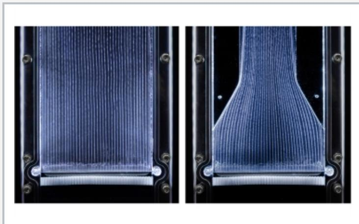
Visualización de líneas de corriente con burbujas de hidrógeno
