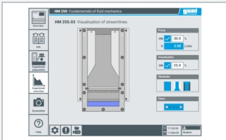
Interfaz de usuario intuitivo en la pantalla táctil: vista general de ensayos con el ajuste del caudal y la corriente para la electrólisis con fines de visualización
