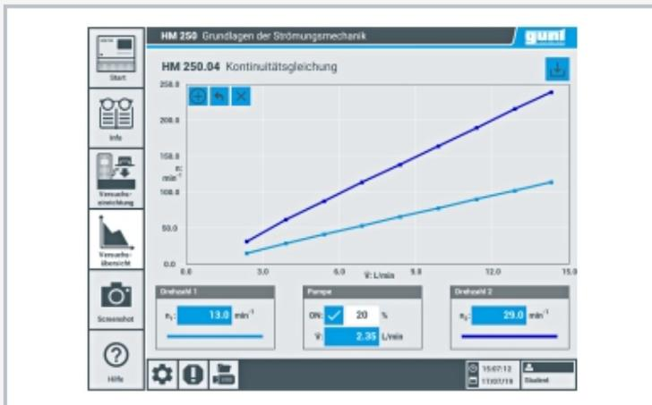
Interfaz de usuario intuitivo en la pantalla táctil de HM 250: representación gráfica de los valores medidos, números de revoluciones de las dos ruedas de aletas en diferentes áreas de la sección transversal de la sección de tubo.
