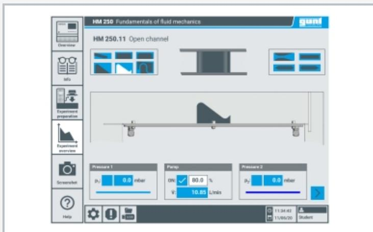
Interfaz de usuario intuitivo en la pantalla táctil de HM 250: medición de la presión durante la descarga sobre la presa-vertedero de perfil Ogee con salto de esquí
