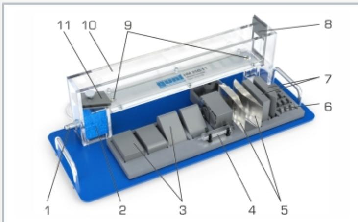
1 alimentación de agua, 2 inserto de espuma para la estabilización del agua en la entrada, 3 vertederos, 4 jeringa para excitar olas en la superficie del agua, 5 canal de Venturi, 6 obstáculos para la disipación de energía, 7 pilares, 8 vertedero en la salida de agua, 9 conexiones para presión, 10 canal de ensayo, 11 tobera para crear un flujo acelerado
