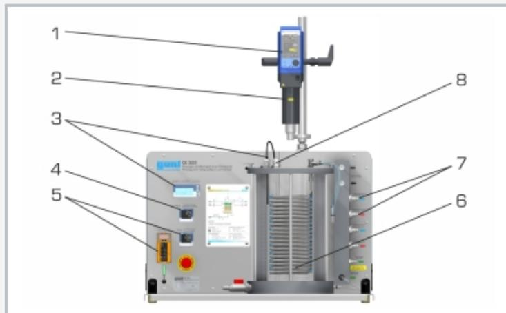
1 agitador, 2 medición del par, 3 medición de la conductividad eléctrica, 4 ajuste de la temperatura, 5 ajuste del caudal para el gas, 6 serpentín, 7 conexiones para agua caliente, agua fría y gas, 8 conexiones libres para otros instrumentos de medición
