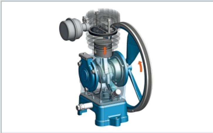
Vista transparente del compresor de émbolo montado (captura de pantalla del vídeo de montaje)
