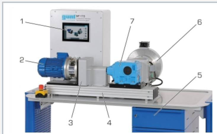
1 pantalla táctil para el manejo, 2 motor de accionamiento, 3 revestimiento de protección, 4 placa base para el alojamiento del motor y el engranaje, 5 herramientas, 6 freno, orientable, 7 MT 123 Engranaje recto de tornillo sin fin
