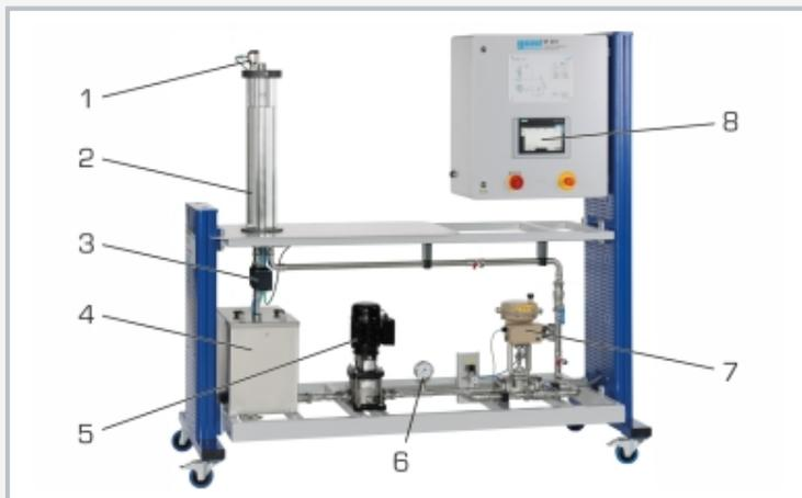
1 sensor de nivel inteligente, 2 depósito transparente, 3 válvula proporcional con accionamiento a motor, 4 depósito de reserva, 5 bomba, 6 manómetro, 7 válvula de control, 8 pantalla táctil
