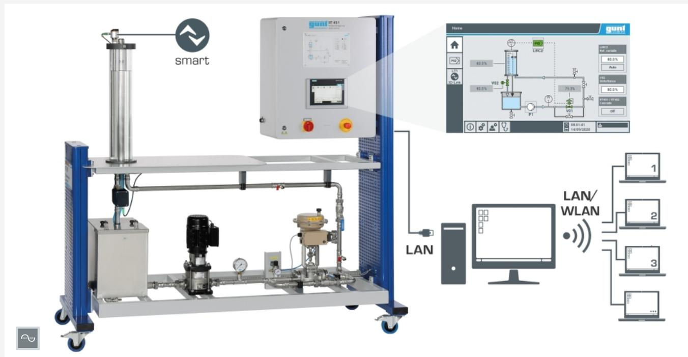
Control y manejo a través de la pantalla táctil o a través de un ordenador con el software GUNT. Observación y evaluación de los ensayos en un número ilimitado de puestos de trabajo a través de LAN/WLAN.
