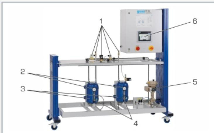
1 varias válvulas, 2 manómetro, 3 depósito a presión, 4 sensor de presión, 5 válvula de control, 6 pantalla táctil
