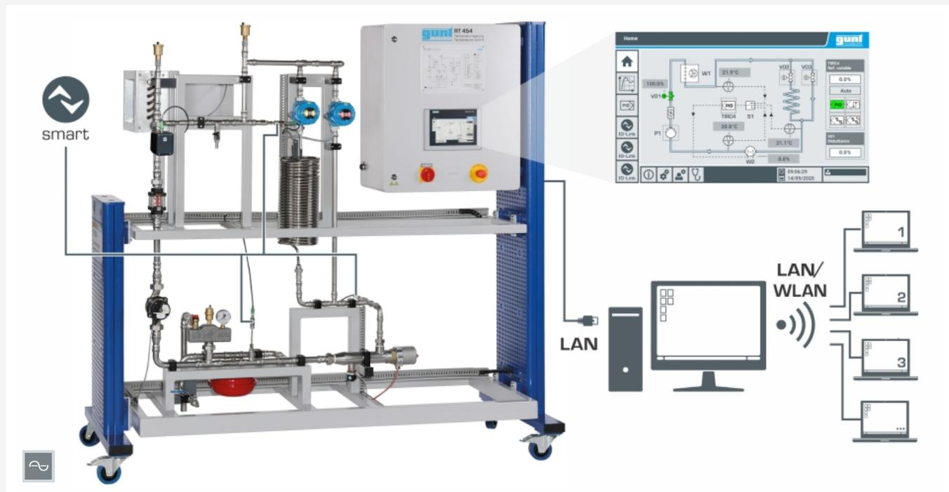
Control y manejo a través de la pantalla táctil o a través de un ordenador con el software GUNT. Visualización y seguimiento de los ensayos en un número ilimitado de puestos de trabajo a través de LAN/WLAN.
