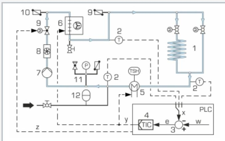
1 sistema controlado: sección de tubo con secciones de retardo, 2 elemento de medición: sensor de temperatura inteligente, 3 comparador: componente del PLC, 4 regulador digital integrado en el PLC, 5 actuador: dispositivo de calefacción, 6 actuador: unidad de refrigeración, 7 bomba, 8 indicador de caudal, 9 las variables de perturbación se generan a través de válvula proporcional con accionamiento a motor, 10 válvula de purga, 11 grupo de seguridad, 12 depósito de compensación
