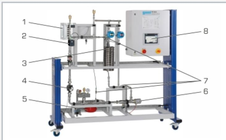
1 unidad de refrigeración (cambiador de calor aire-agua con soplante), 2 válvula proporcional con accionamiento a motor, 3 secciones de retardo, 4 bomba, 5 depósito de compensación, 6 dispositivo de calefacción, 7 sensores de temperatura inteligentes, 8 pantalla táctil
