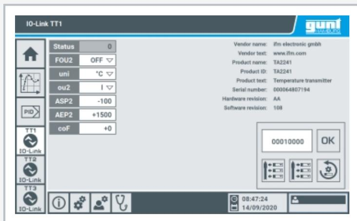
Captura de pantalla del PLC: Configuración de los sensores de temperatura inteligentes a través de IO-Link
