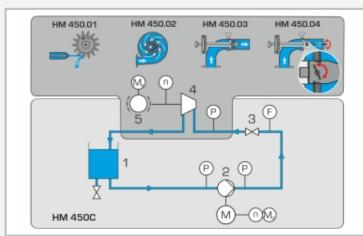
1 depósito, 2 bomba, 3 válvula de estrangulación, 4 turbina, 5 freno, M motor; F caudal, P presión, n número de revoluciones,  $M_{\rm d}$  par
