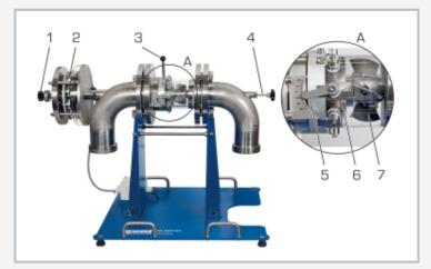
1 volante de mano para ajustar el freno, 2 freno de corrientes parásitas, 3 ajuste de los álabes distribuidores, 4 volante de mano para ajustar los álabes móviles; A representación detallada
