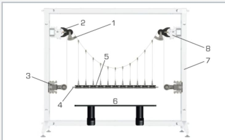
1 medidor de ángulos, 2 polea para montar en el apoyo, 3 elemento de fijación para el cable de sustentación, 4 varillas para reforzar la calzada, 5 calzada con 11 secciones, 6 bandeja para tarar y como elemento auxiliar de montaje; accesorios: 7 bastidor de montaje SE 200, 8 apoyo SE 200.21
