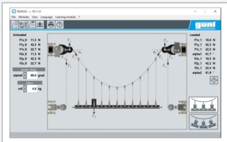
Captura de pantalla del software GUNT: indicación de los esfuerzos de los soportes y de los cables, así como del ángulo del cable de sustentación en los soportes
