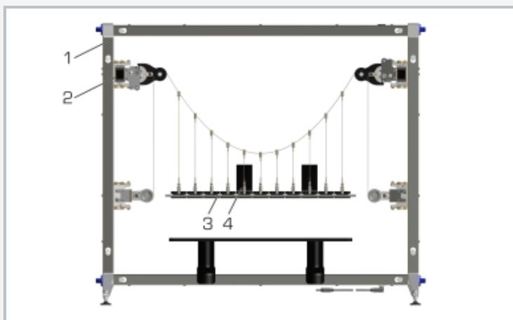
Montaje a modo de ejemplo: 1 bastidor de montaje SE 200, 2 dos apoyos SE 200.21, 3 calzada rígida, 4 dos cargas SE 200.25
