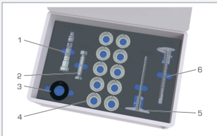
1 micrómetro interno de 3 puntos, 2 calibre límite, 3 anillo de ajuste, 4 objeto a comprobar (cubo), 5 pie de rey de profundidades, 6 pie de rey
