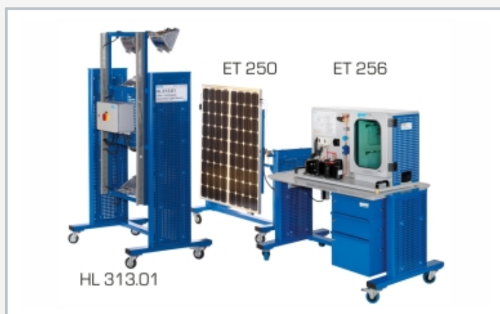
ET 256 junto con la fuente de luz artificial opcional HL 313.01 y los módulos solares ET 250
