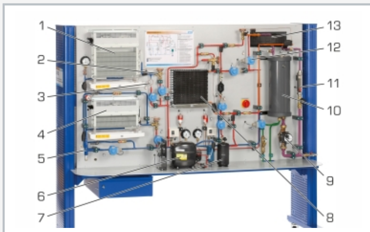
1 evaporador, 2 válvula de expansión, 3 tubo capilar, 4 evaporador (congelación), 5 regulador de la presión de evaporación, 6 compresor, 7 recipiente, 8 cambiador de calor con soplante, 9 bomba, 10 depósito para la mezcla de agua-glicol, 11 caudalímetro, 12 válvula electromagnética, 13 cambiador de calor de espiralado coaxial
