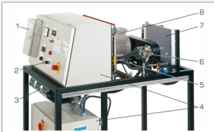
1 caja con pulsadores activadores de fallos, 2 cerradura del encendido, 3 refrigerador de aire con soplante de tres etapas, 4 armario de distribución, 5 caudalímetro, 6 compresor, 7 condensador con soplante, 8 electromotor
