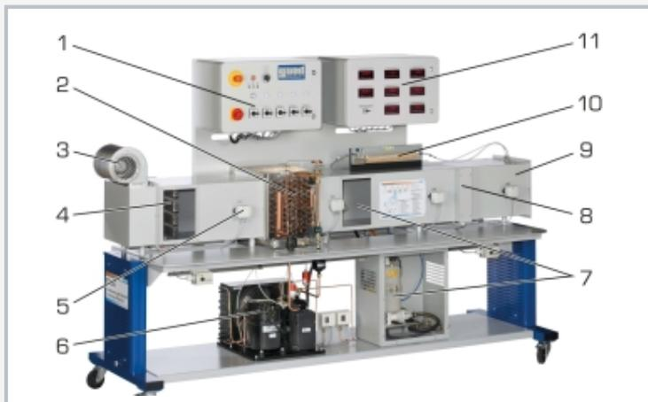
1 elementos de mando, 2 refrigerador de aire (evaporador directo), 3 soplante, 4 precalentador de aire, 5 sensor de temperatura, 6 grupo frigorífico, 7 humidificador de aire, 8 postcalentador de aire, 9 conducto de aire, 10 manómetro de tubo inclinado, 11 elementos de indicación
