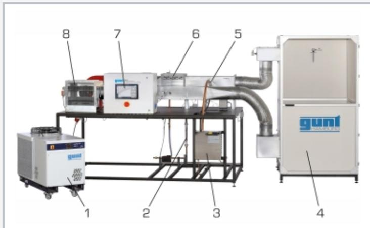
1 enfriador de agua, 2 caudalímetro, 3 humidificador de vapor, 4 cámara climática, 5 distribuidor de vapor (humidificador), 6 refrigerador de aire, 7 regulador climático PLC, 8 entrada de aire exterior con soplante; cubierto: calentador de aire
