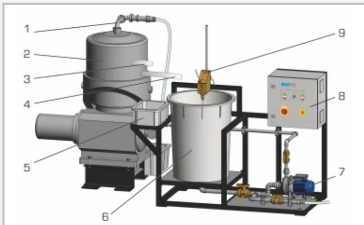
1 entrada de la emulsión, 2 centrifugadora, 3 salida de fase ligera, 4 salida de fase pesada, 5 depósito colector de fase ligera, 6 depósito de agitación, 7 bomba, 8 caja de distribución con elementos de mando, 9 mecanismo de agitación
