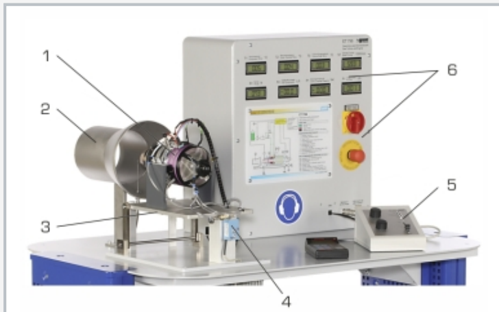
1 motor a reacción, 2 tubo de mezcla, 3 mesa de turbina, 4 sensor de fuerza para medir el empuje, 5 elementos de mando de la turbina de gas, 6 elementos de indicación y mando banco de ensayos
