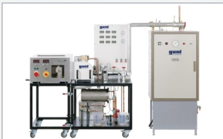
Montaje experimental listo para el funcionamiento: izquierda: unidad de frenado HM 365, centro: máquina de vapor de dos cilindros ET 813, derecha: generador de vapor ET 813.01
