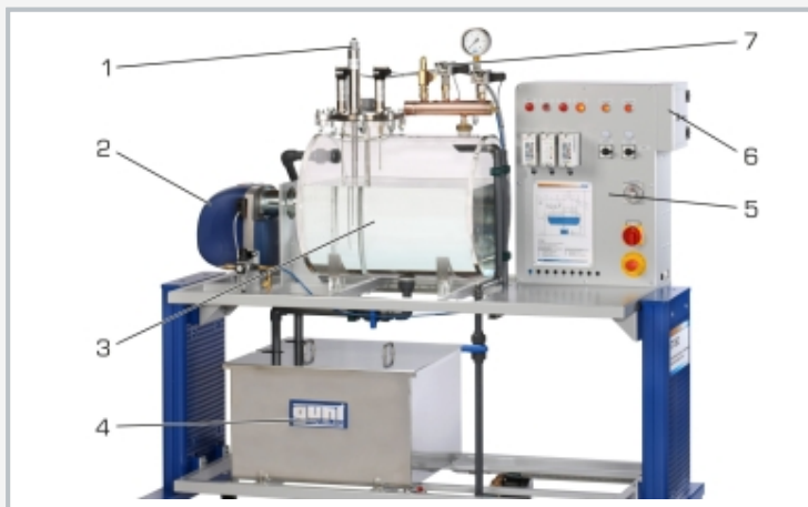
1 supervisión del nivel del agua , 2 quemador, 3 modelo de caldera de vapor, 4 depósito de alimentación, 5 armario de distribución, 6 caja de distribución para los fallos, 7 dispositivos para medir la presión
