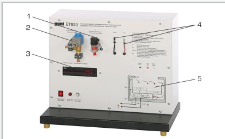
1 sensor de presión, 2 válvula de expansión electrónica, 3 pantalla del regulador de refrigeración, 4 sensor de temperatura, 5 esquema del congelador simulado
