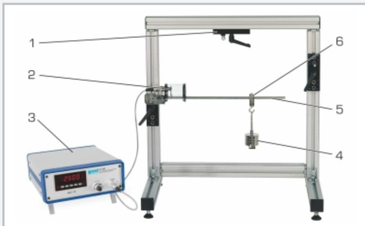
1 soporte, 2 punto de medición con galgas extensométricas, 3 amplificador de medición, 4 peso, 5 viga de flexión, 6 corredera
