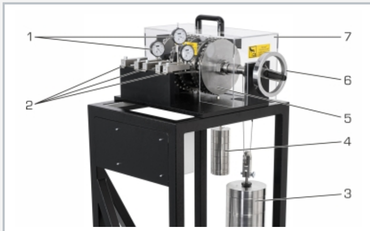
1 relojes comparadores, 2 vigas de flexión, 3 juego de pesas, 4 juego de pesas para la medición de las relaciones de transmisión, 5 engranaje planetario, 6 volante manual, 7 cubierta
